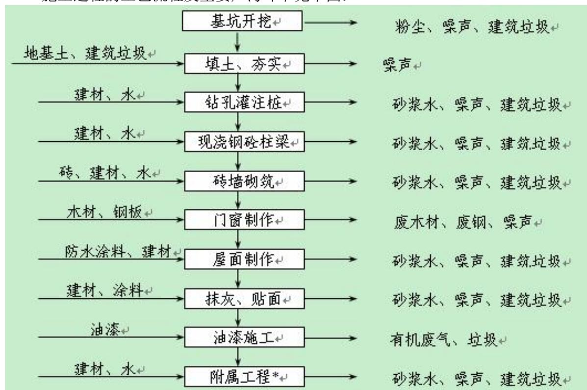
图 5-1 施工期建筑工艺流程图
